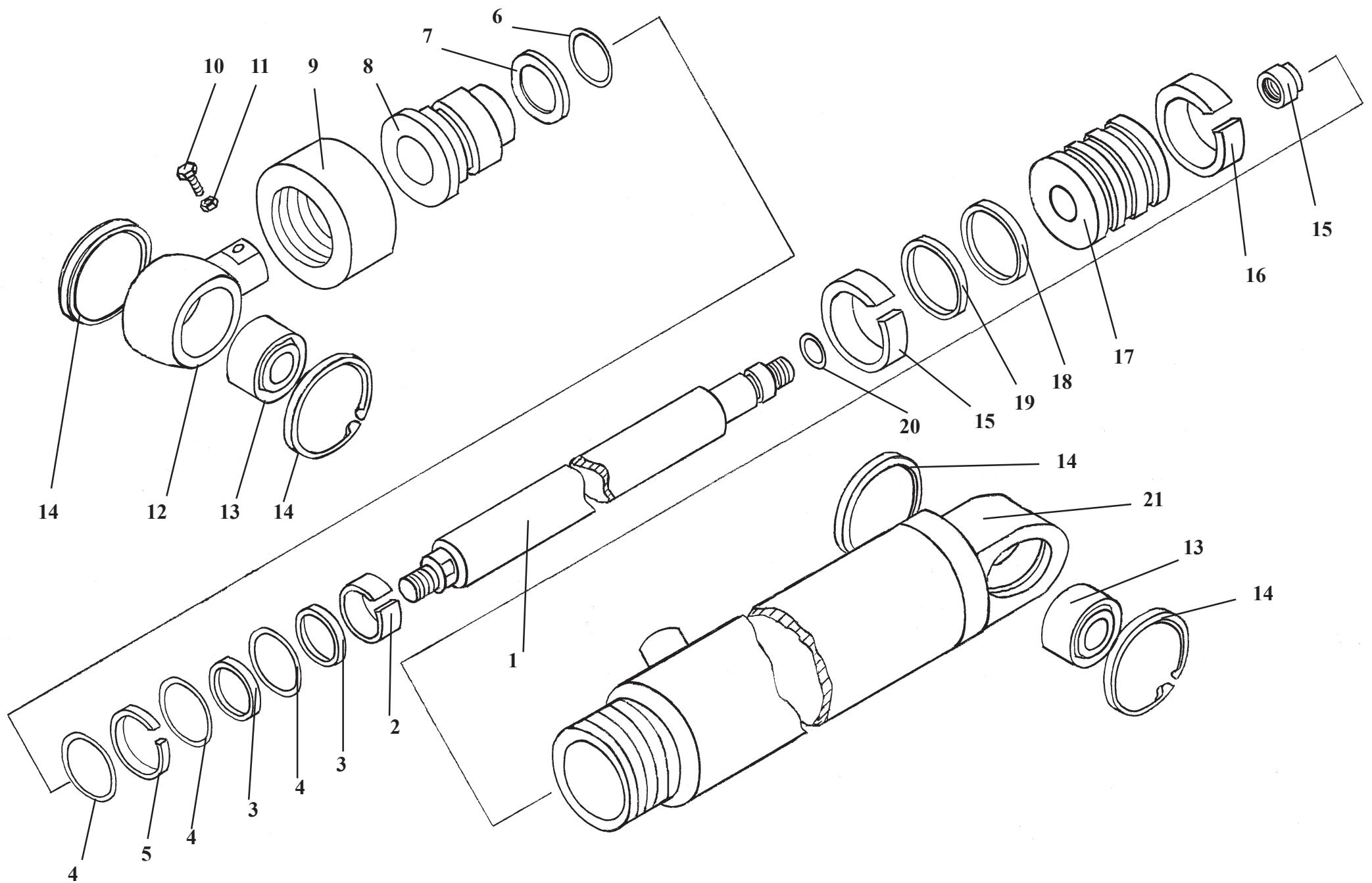
Рис. 52. / Fig. 52. ТО-28А.08.05.000 Цилиндр рулевой / Steering cylinder
