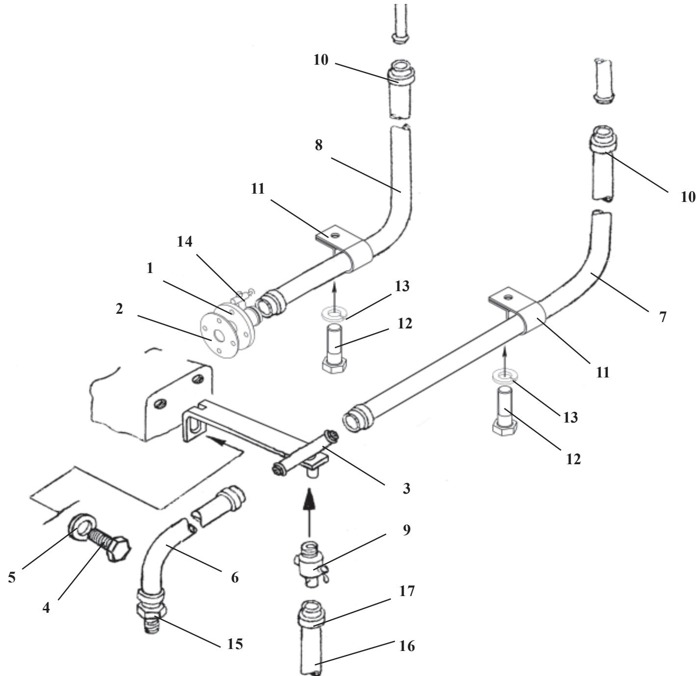
**TO-28A.20.00.000****Установка трубопроводов отопителя****Рис. 38****Cab heater****Fig. 38**
