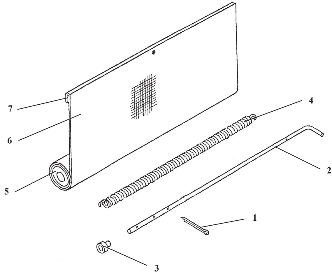
**TO-18.02.11.000****Шторка радиатора****Рис. 71****Radiator shutter****Fig. 71**
