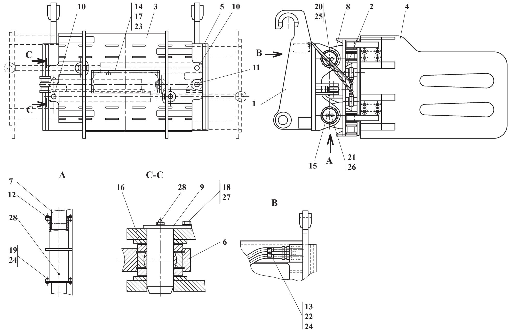
**342C.62.00.000****Захват лаповый****Рис. 90****Bale clamp****Fig. 90**
