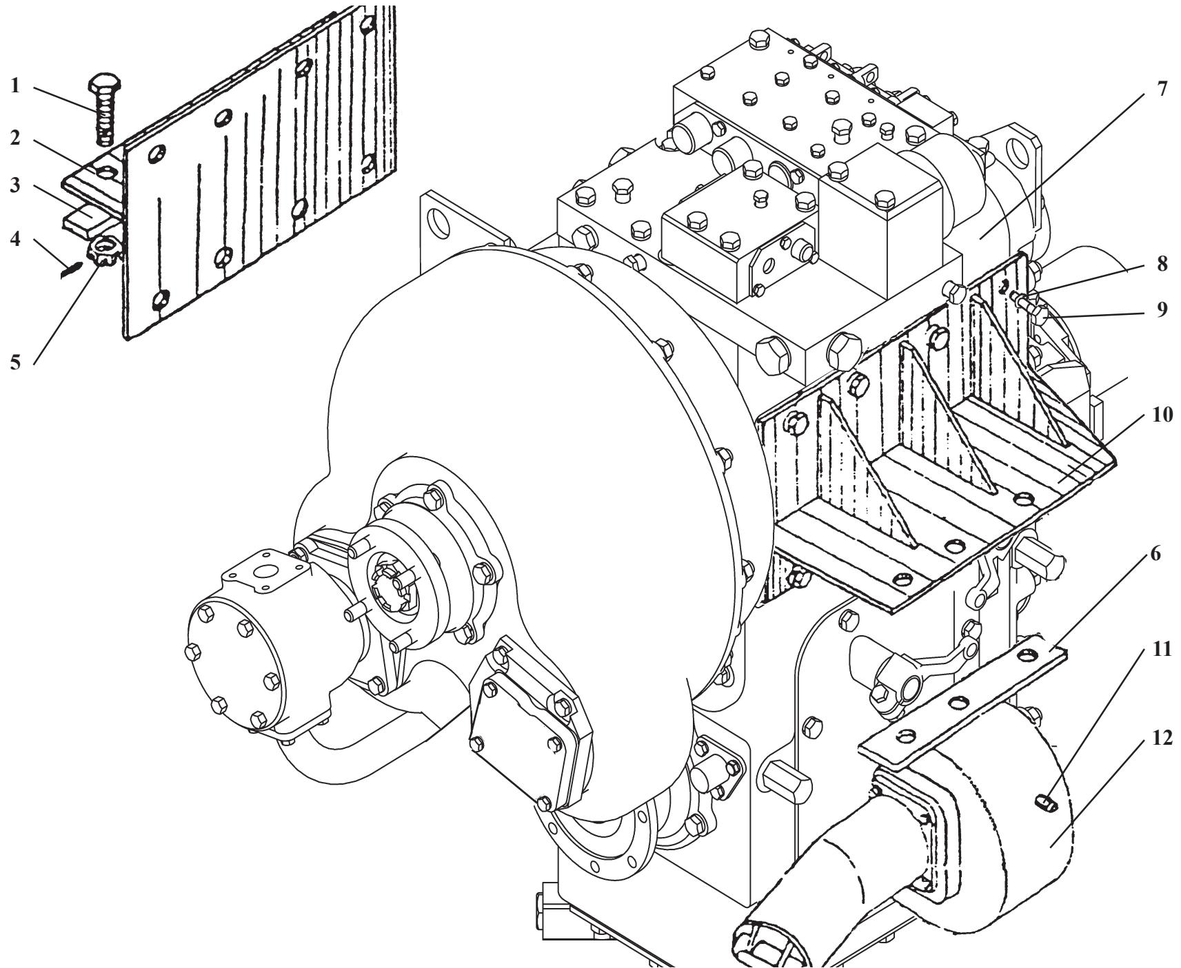
**TO-18Б.74.00.000-01****Установка ГМП****Рис. 4****Hydromechanical transmission setup****Fig. 4**
