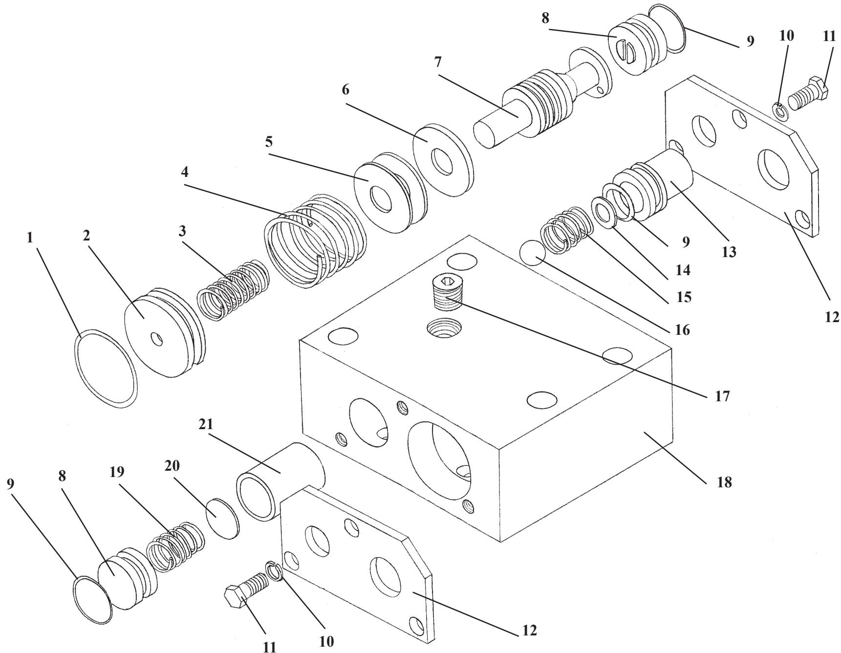
Рис. 20. / Fig. 20. Y35.615-12.140 Блок клапанов/ Valve block
