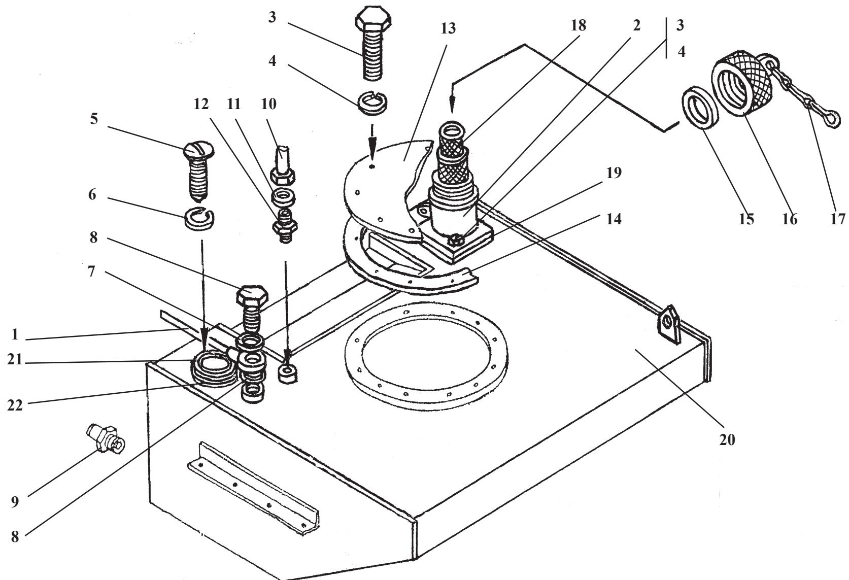
**TO-28A.02.02.000****Топливный бак****Рис. 73****Fuel tank****Fig. 73**
