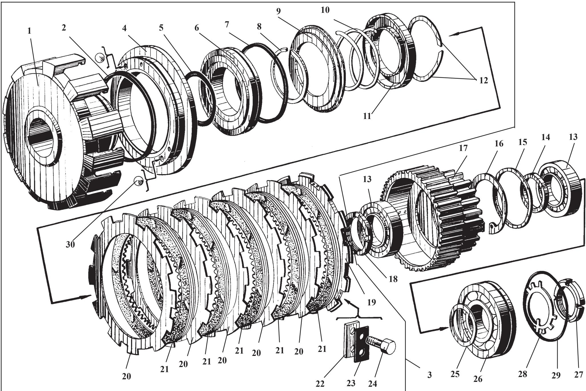
**У35.615-01.050****Вал турбинный****Рис. 10****Turbine shaft****Fig. 10**
