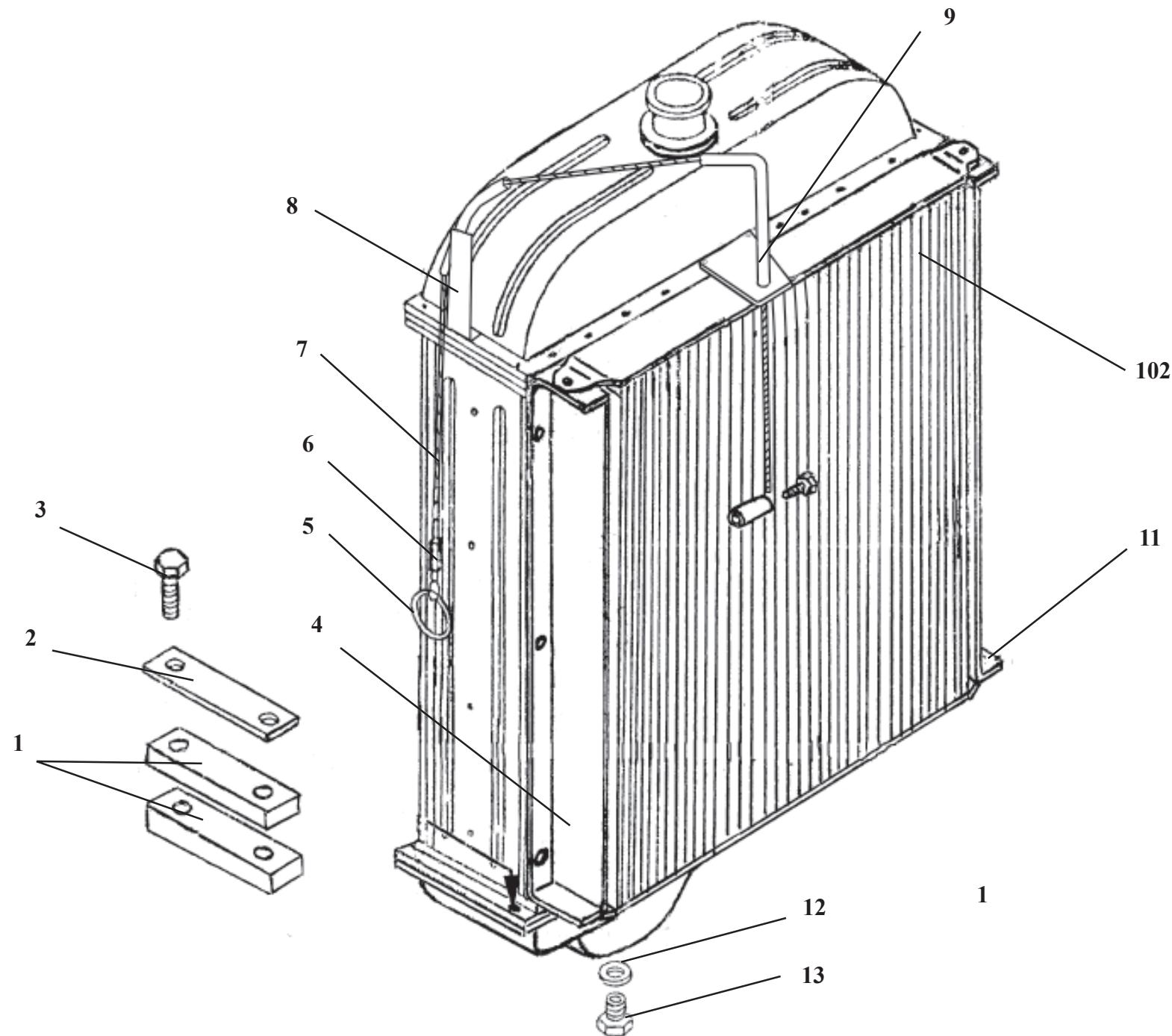
**TO-28A.02.14.000****Установка радиаторов****Рис. 76****Radiator setup****Fig. 76**
