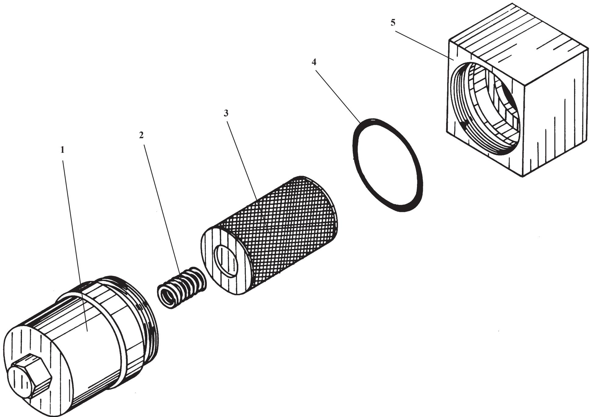
Рис. 17. / Fig. 17. У35.615-12.100      Фильтр / Filter
