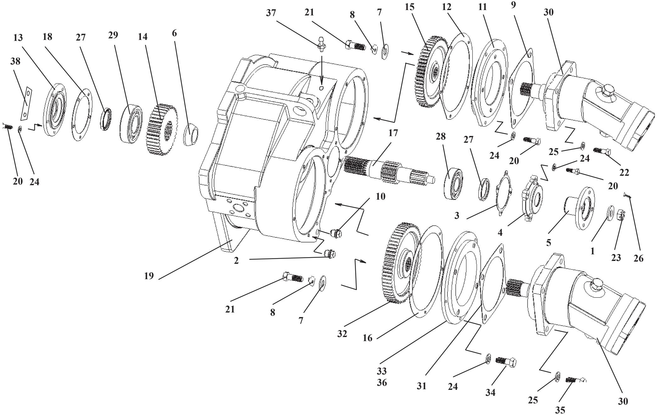
**TO-28A.02.04.000-01****Редуктор отбора мощности****Рис. 74****Power take-off reducer****Fig. 74**
