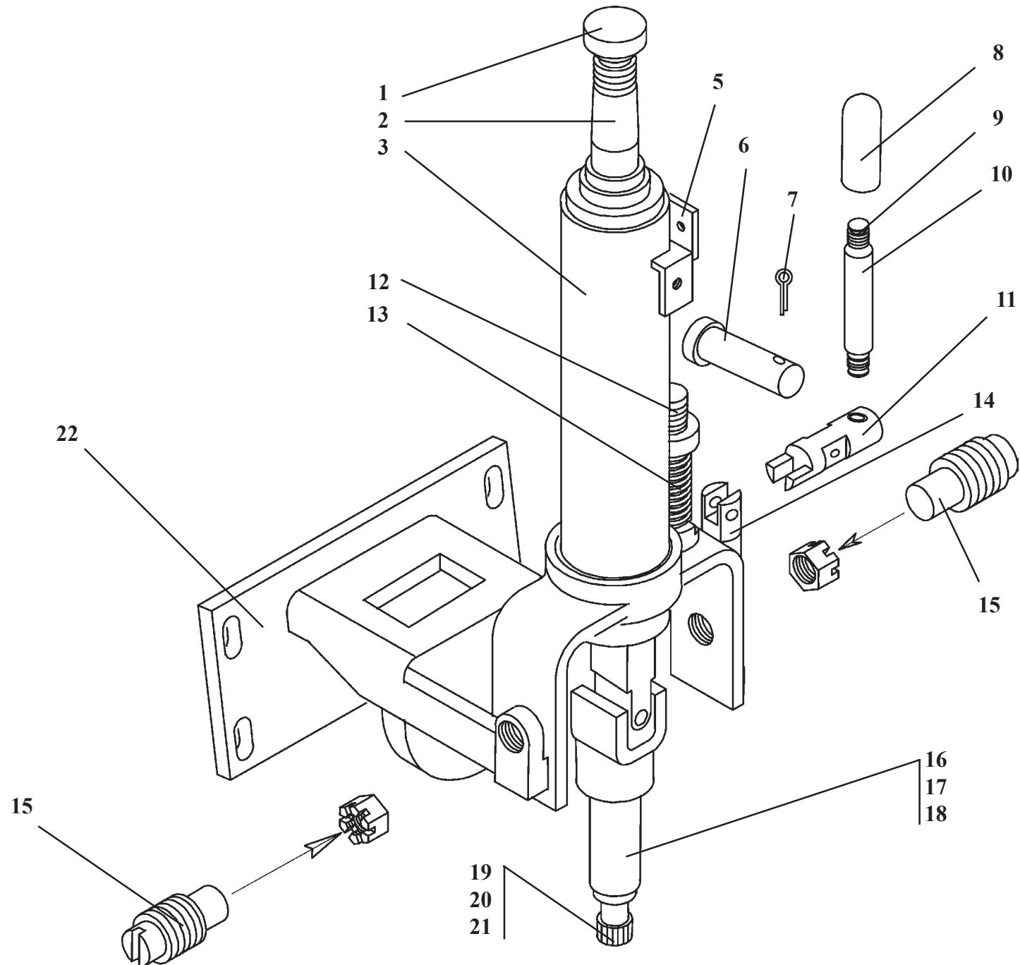
**У7810.7-9.02.01.750-01****Привод гидроруля****Рис. 33****Steering unit actuator****Fig. 33**
