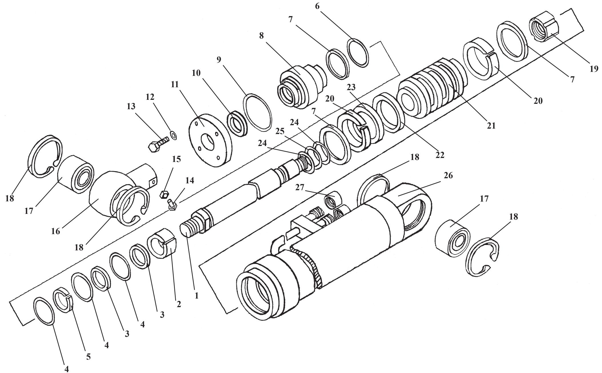
**TO-18Б.06.23.000****Цилиндр ковшовый****Рис. 47****Tilt cylinder****Fig. 47**
