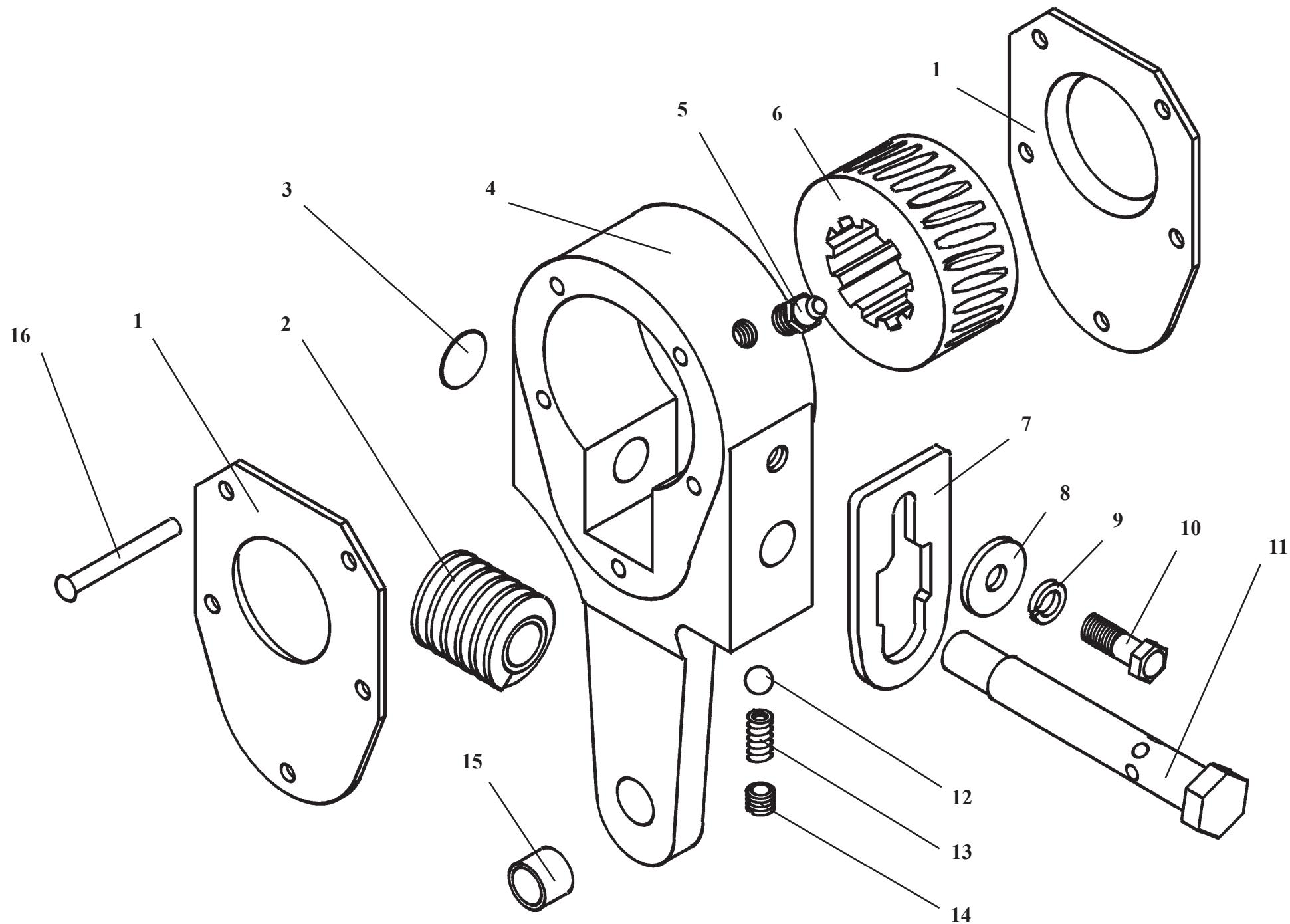
**У2210.20Н-03.080****Рычаг регулировочный****Рис. 64б****Adjusting lever****Fig. 64b**
