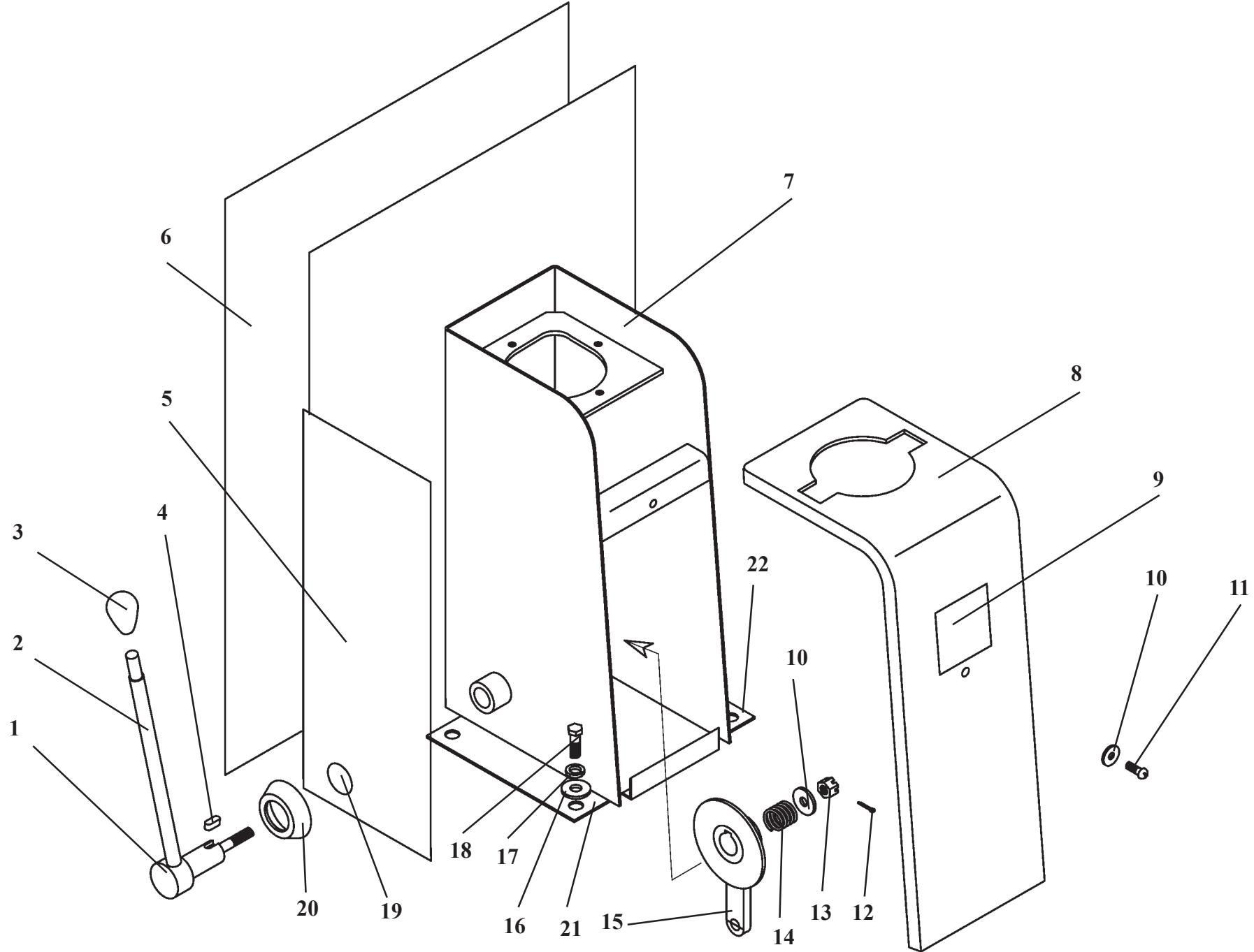
**У7810.7-9.02.02.500-01****Блок управления****Рис. 30****Pilot control unit****Fig. 30**
