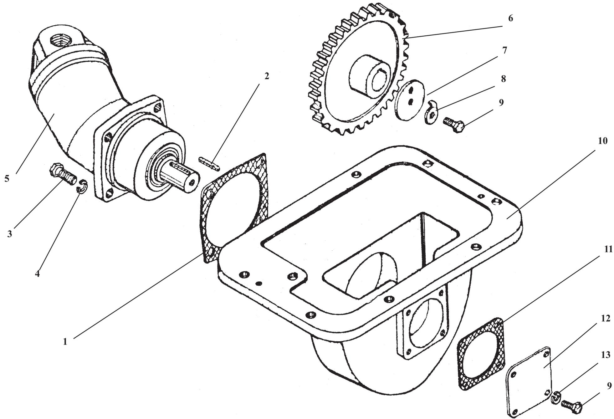
Рис. 21 / Fig. 21 Т0-18.03.01.000 Редуктор отбора мощности на аварийный насос руля /
