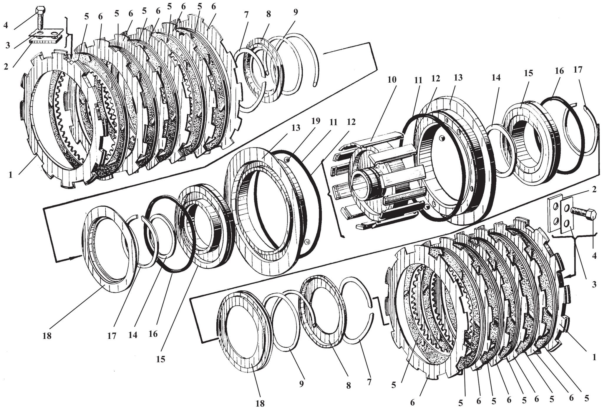
**У35.615-01.070****Фрикцион****Рис. 15****Friction clutch****Fig. 15**
