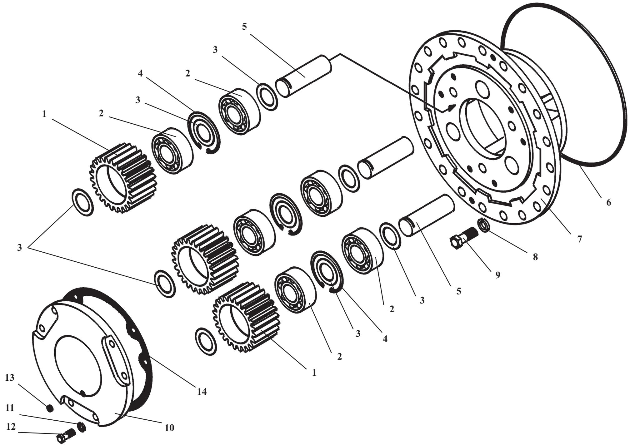
Рис. 59 / Fig. 59. У2210.03А-00.030 Водило с сателлитами / Carrier with planet pinions
