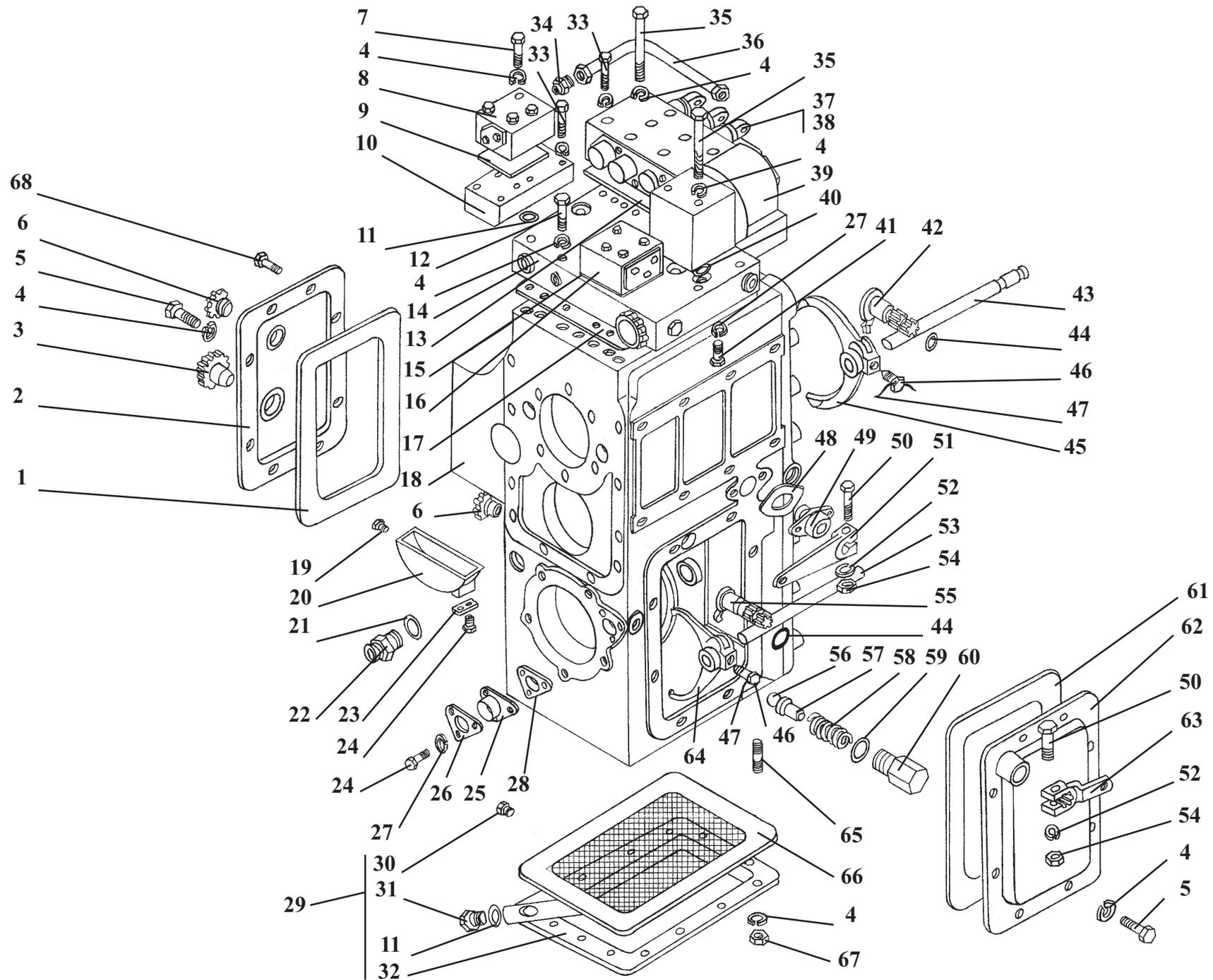
**У35.615-00.000****Передача гидромеханическая****Рис. 5****Hydromechanical transmissions****Fig. 5**
