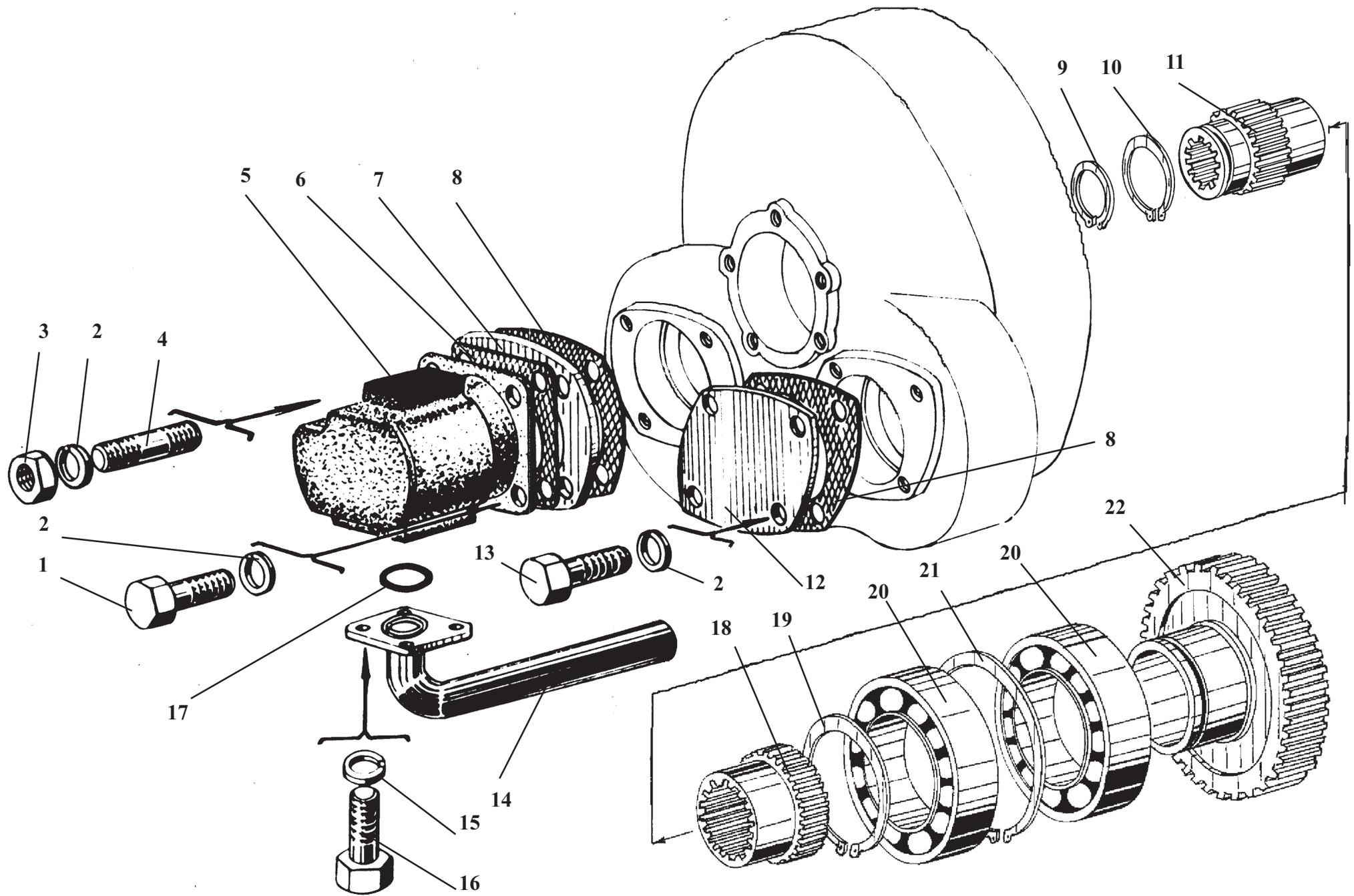
**У35.615-00.000****Передача гидромеханическая****Рис. 8****Hydromechanical transmissions****Fig. 8**
