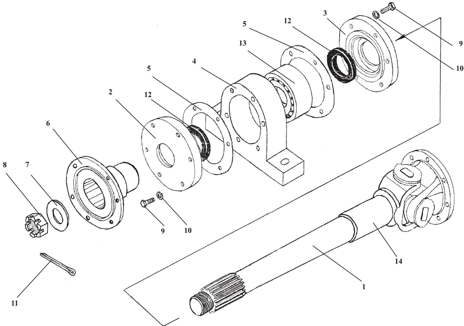
**ТО-28А.04.00.100****Вал карданный****Рис. 53****Propeller shaft****Fig. 53**
