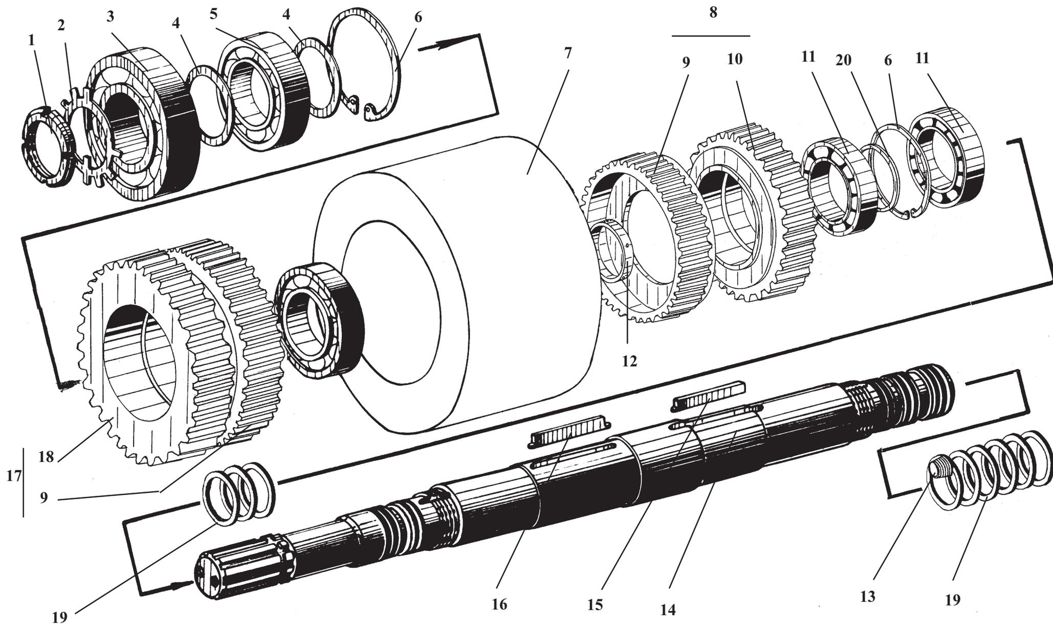
**У35.615-00.000****Передача гидромеханическая****Рис. 9****Hydromechanical transmission****Fig. 9**
