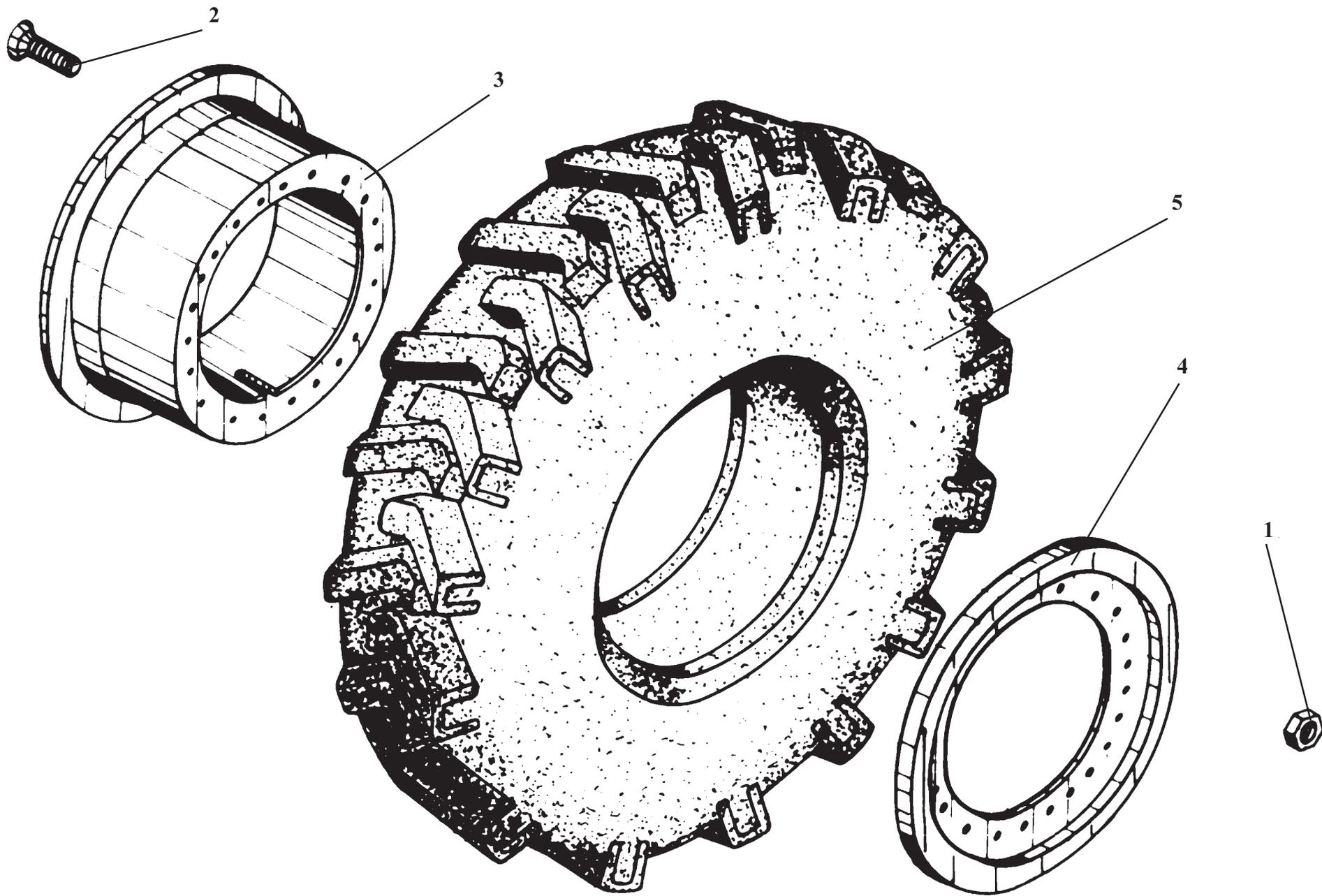
**ТО-18А.05.05.000****Колесо****Рис. 55****Wheel****Fig. 55**
