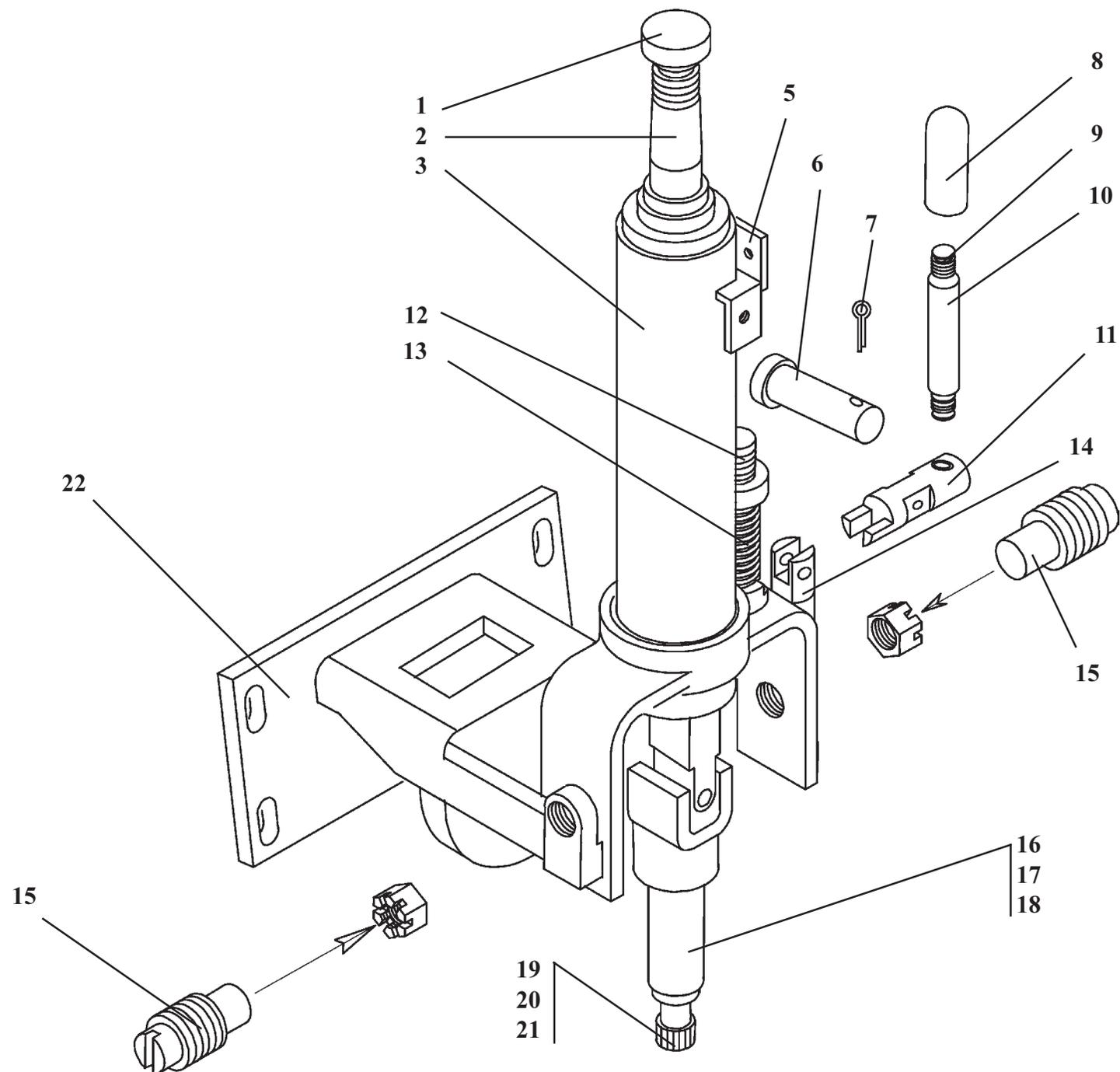
**У7810.7-9.02.01.750-01****Привод гидроруля****Рис. 33****Steering unit actuator****Fig. 33**
