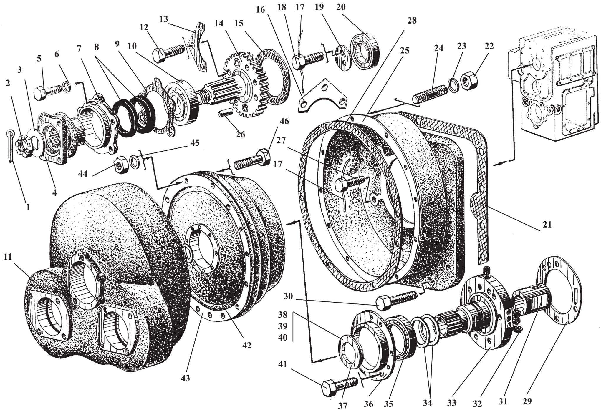
**У35.615-00.000****Передача гидромеханическая****Рис. 7****Hydromechanical transmissions****Fig. 7**
