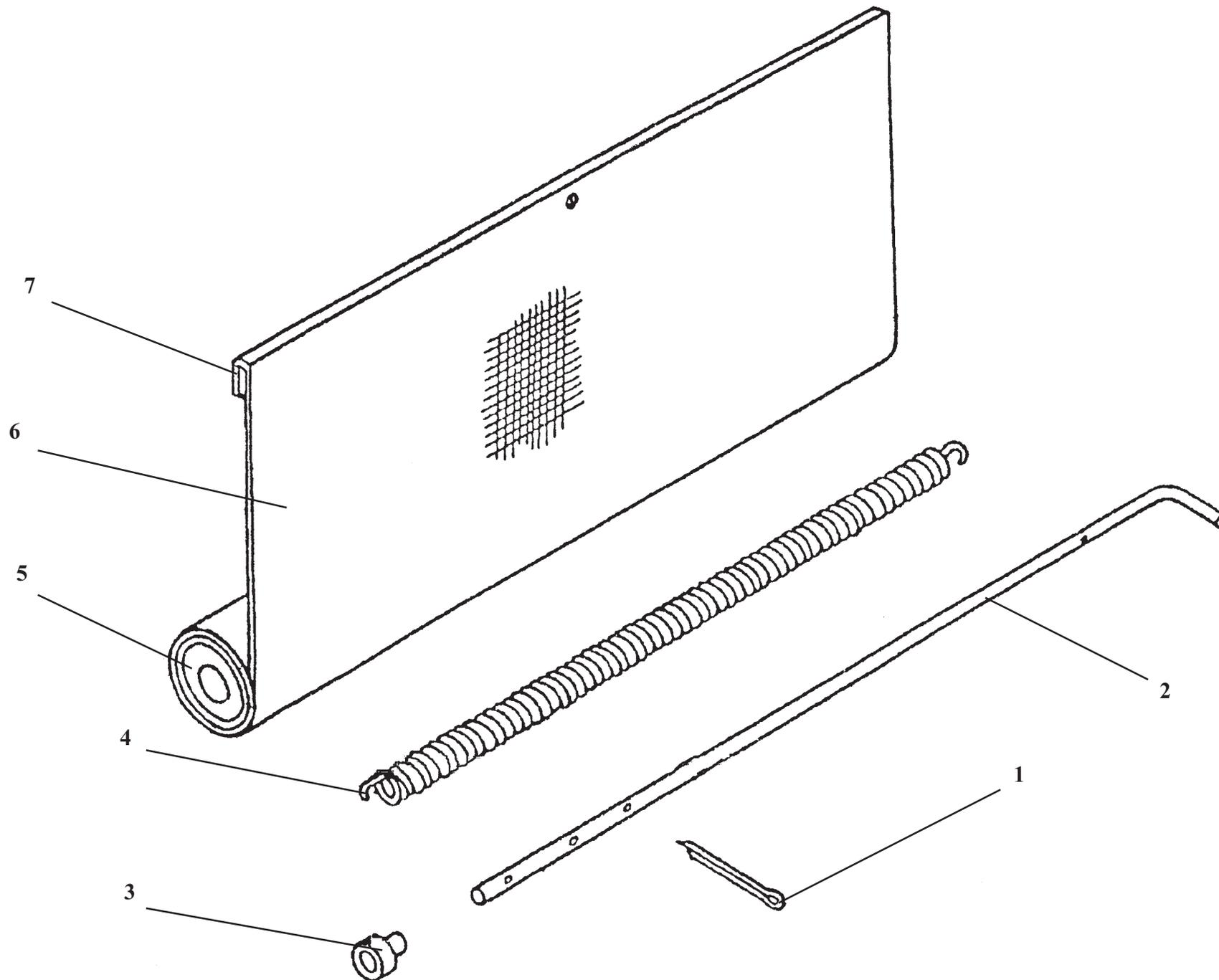
**ТО-18.02.11.000****Шторка радиатора****Рис. 70****Radiator shutter****Fig. 70**
