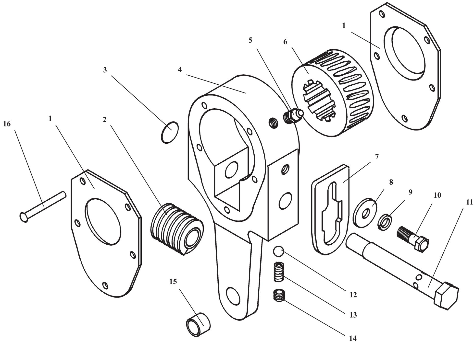
**У2210.20Н-03.080****Рычаг регулировочный****Рис. 63****Adjusting lever****Fig. 63**
