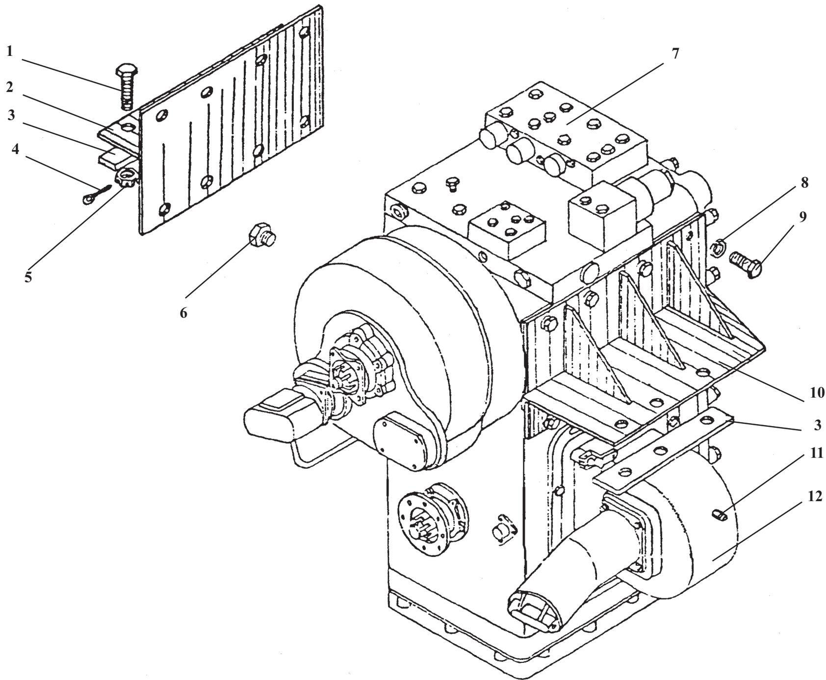
**ТО-18Б.74.00.000****Установка ГМП****Рис. 4****Hydromechanical transmission setup****Fig. 4**
