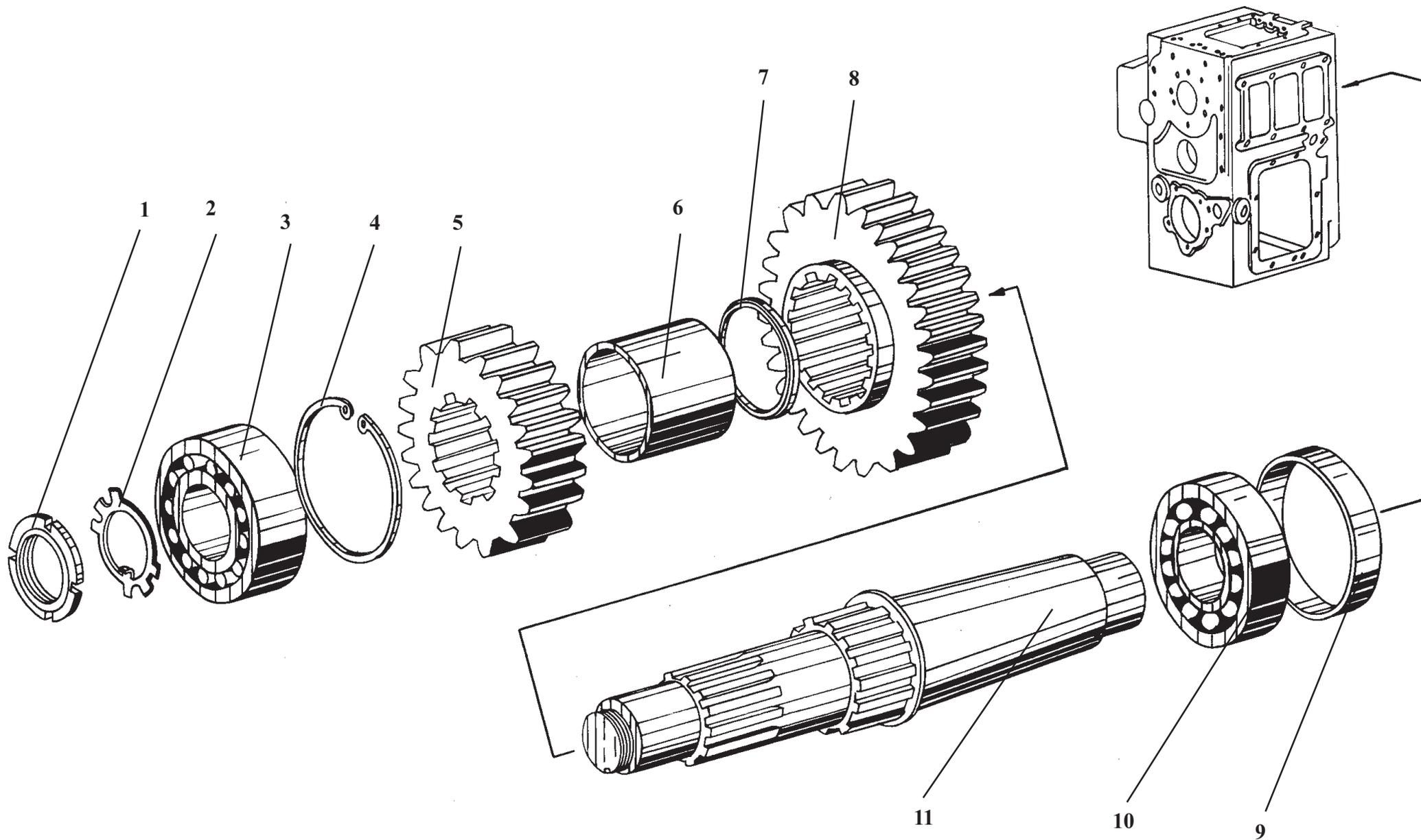
**У35.615-00.000****Передача гидромеханическая****Рис. 12****Hydromechanical transmission****Fig. 12**
