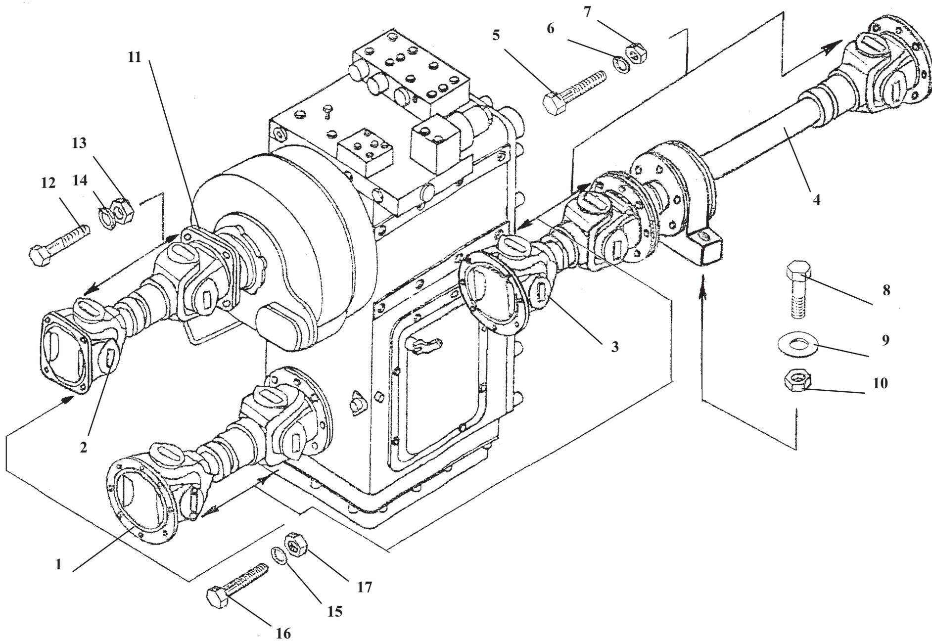
Рис. 52 / Fig. 52. ТО-28А.04.00.000 Установка карданных валов / Propeller shafts setup
