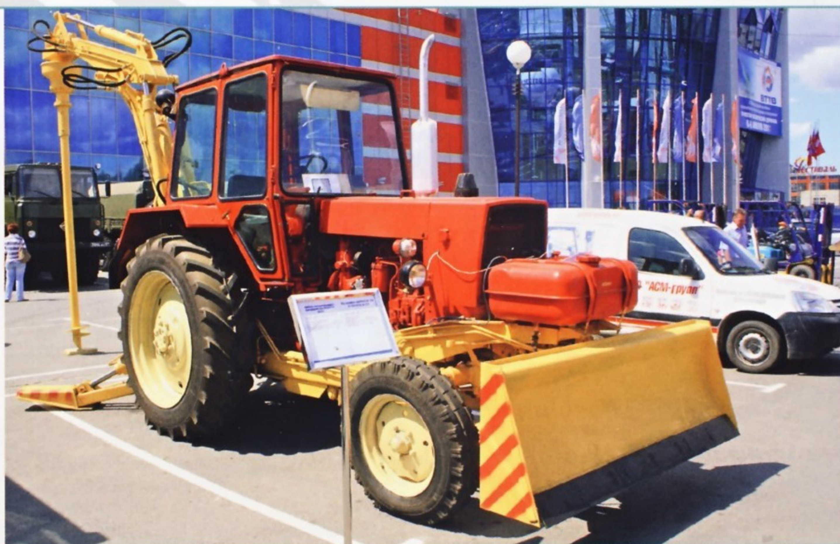
Экскаватор ЭО-2621 с бульдозерным отвалом и свезавинчивающим оборудованием.
