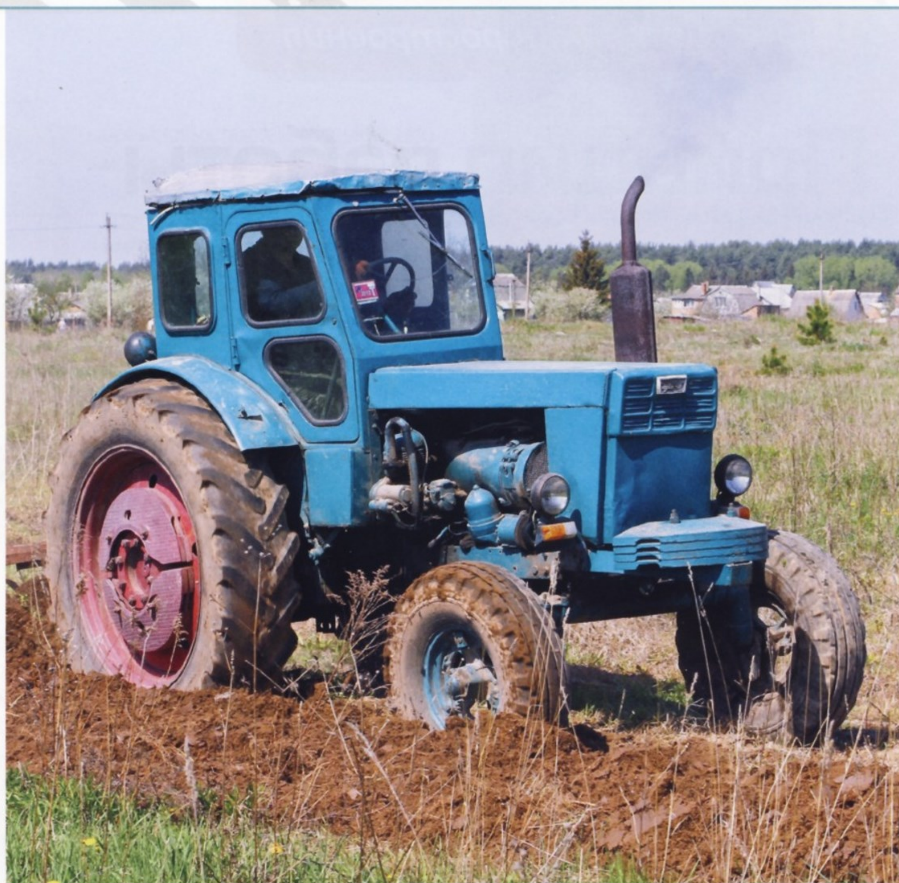
Елочные грунтозацепы Т-40А обеспечивают хорошее сцепление с почвой.
