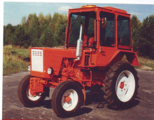
В двигателе Д-21 трактора Т-25А применен уравновешивающий механизм, который устраняет вибрацию.
